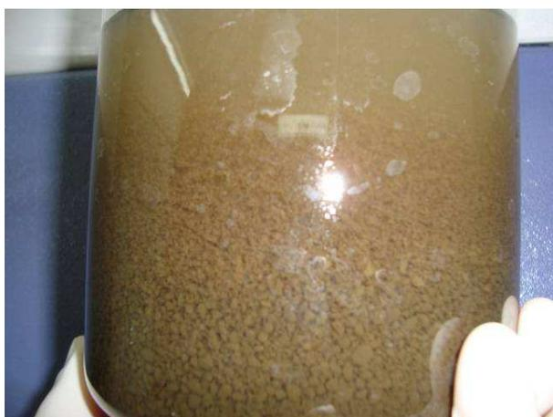
**Figura 2.4.** Lodo granular utilizado en la inoculación
