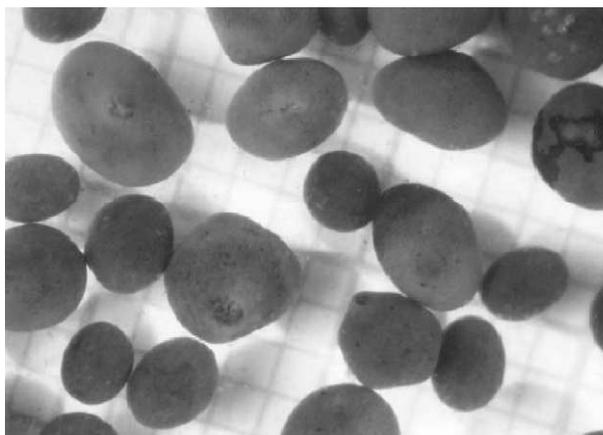
**Figura 1.6.** Gránulos Anaerobios de un reactor RANMAL [103]
