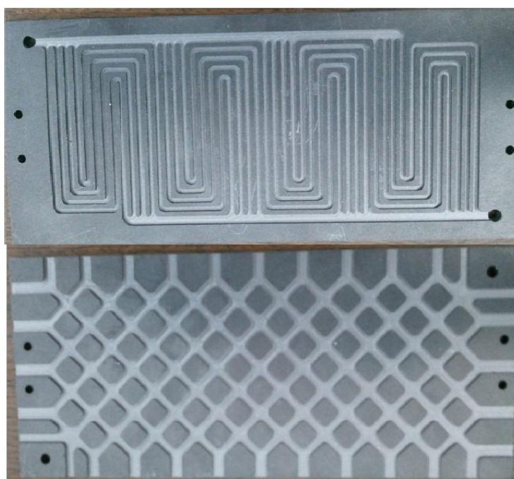
Figura 21. Platos bipolares maquinados material compuesto de grafito/PP.
