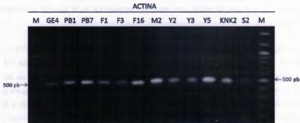
**Figura 7.** Electroforésis en gel de agarosa al 1.5% de los fragmentos del gen de actina; se utilizaron los oligos reportados por Arzanlou y colaboradores (2007), específicos de *M. fijiensis*. GE4 = Gran Enano 4, PB1 = Pisang Berlin 1, PB7 = Pisang Berlin 7, F1 = Fougamou 1, F3 = Fougamou 3, F16 = Fougamou 16, M2 = Malaccensis 2, Y2 = Yangambi 2, Y3 = Yangambi 3, Y5 = Yangambi 5, KNK2 = Kluai Namwa Khom 2, S2 = Saba 2. M = Marcador de peso molecular 100 pb (Invitrogen).
