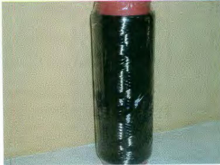
Figura 3.1. Rollo de fibras de carbón IM7 utilizadas para la elaboración de los materiales compuestos.
