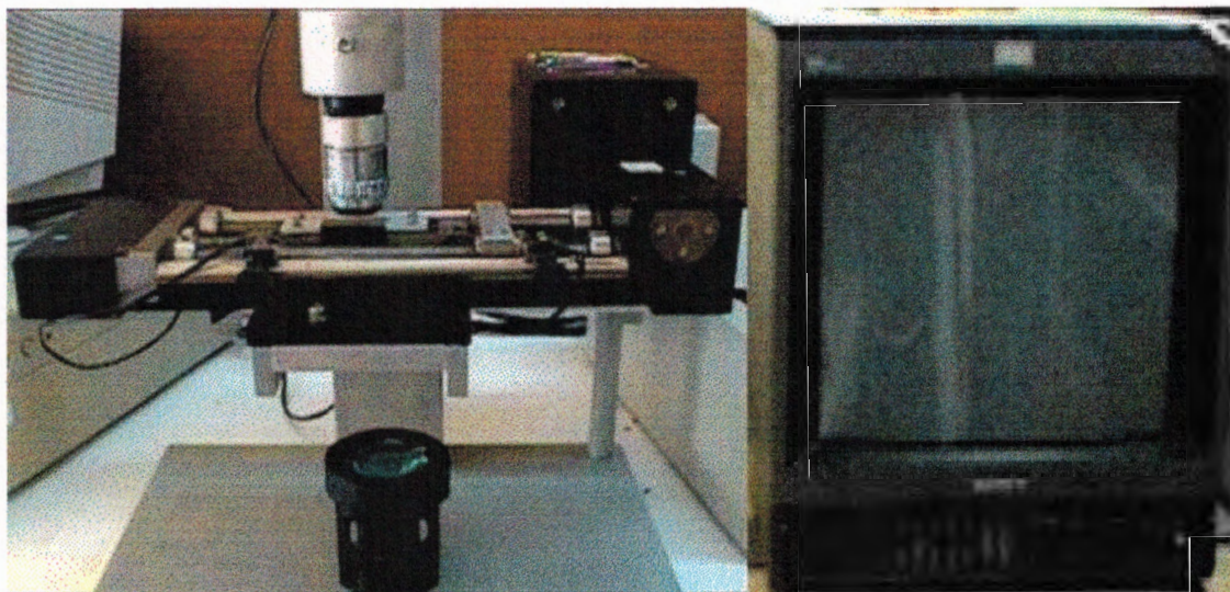
Figura 2.15. Fotografía del equipo para prueba de fragmentación.
