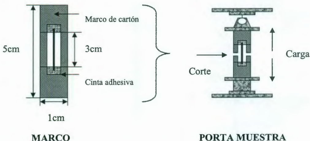
Figura 20.- Marco y porta muestra para realizar las pruebas bajo tensión.
