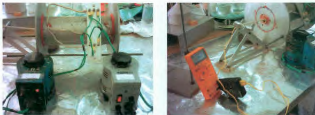
Figura 16.- Controles para regular la temperatura (reóstatos y multímetro).
