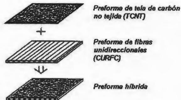
**Figura 1.12.** Concepto de preforma híbrida.
