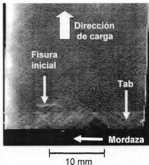
**Figura 3.19.** Fisura inicial en los materiales compuestos PP/Twarón®.
