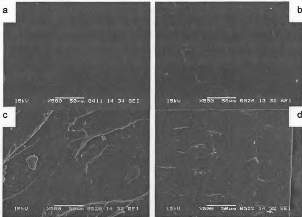
Figura 3.21. Superficie de las probetas de flexión, (a) antes y (b) después de la biodegradación; (c) zona central y (d) del borde de la superficie de ruptura de la matriz de PMMA después de 20 días de biodegradación con *Aspergillus niger*.
