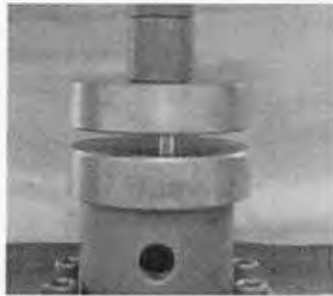
Figura 2.5. Ensayo a la compresión de una muestra de cemento.
