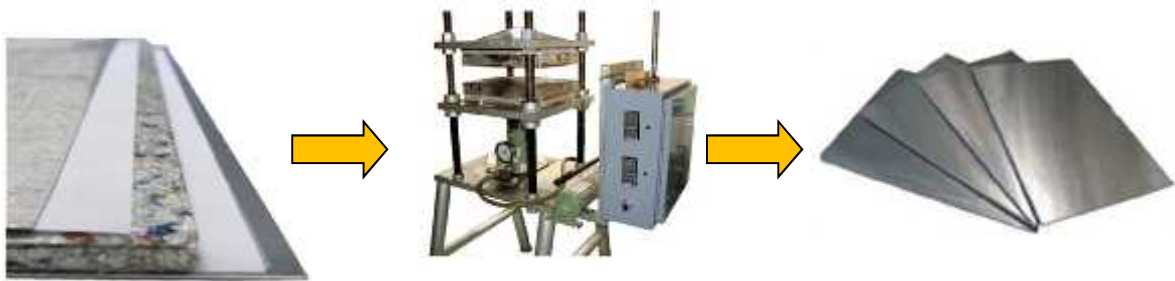
Figura 36. Proceso de consolidación del panel sándwich.
