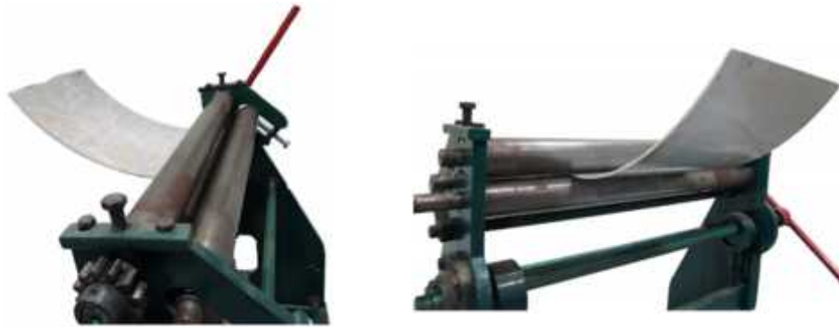
Figura 42. Proceso de rolado del Panel sándwich.
