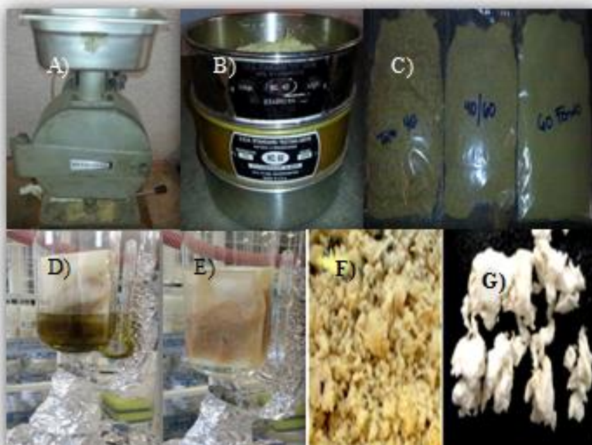
Figura 11. Imagen resumen del procedimiento para la obtención de Holocelulosa. A) Moledora B) Tamiz C) secciones obtenidas en el tamizado (seleccionando la sección 40/60, descrito anteriormente) D) primera extracción con el sistema Soxhlet E) material seleccionado para continuar con la obtención (ultima extracción) F) extracción alcalina G) blanqueo de la Holocelulosa.
