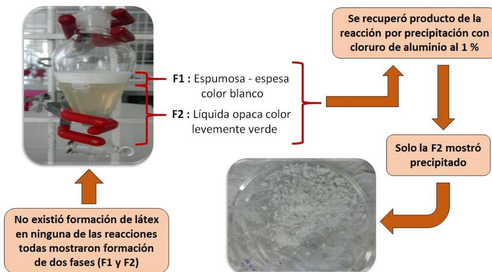
**Figura 3.6** Proceso de obtención de muestra para la caracterización por FTIR para reacciones del limoneno
