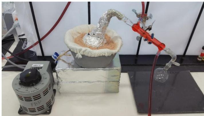
*Figura 2.4. Reactor de despolimerización catalítica sin presión*
