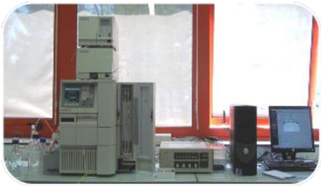
Figura 4. 1. Equipo HPLC Waters 2695 ® acoplado a un detector de fotodiodos en serie (PDA) Waters 2995 ®
