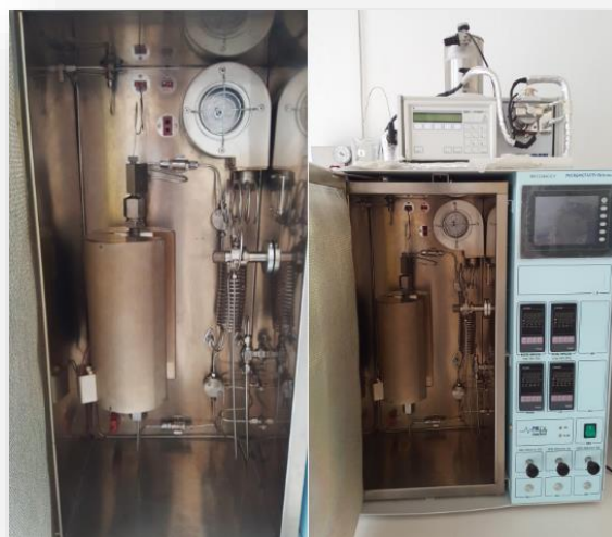
Figura 23. Reactor de lecho fijo
