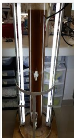
Figura 37. Cultivo de la microalga Scenedesmus obliquus en fotobiorreactor de 20 L con ARS y melaza al 1%.
