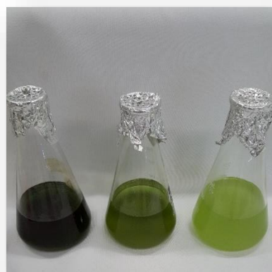
Figura 47. De izquierda a derecha: primera, segunda y tercera extracción de lípidos totales
