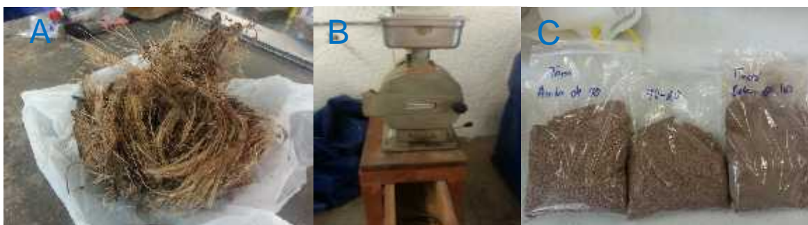
Figura 2.1. A) Bagazo Crudo de Agave cupreata , B) Molino Brabender utilizado para obtener los diferentes tamaños de partícula. C) Fracciones obtenidas.
