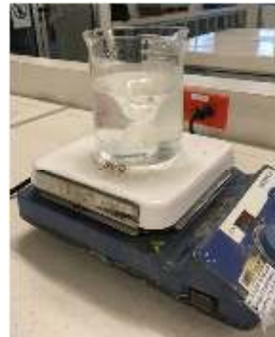
Precipitado y agitación de la muestra por 24h
