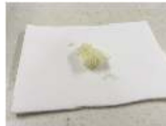
Secado del producto a 60°C/60 kPa por 24h
