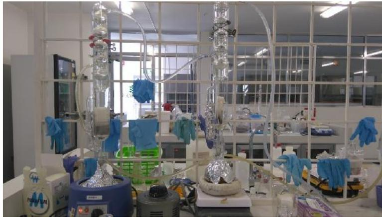
**Figura 2. 2** Extracción de benceno-etanol con equipo sohxlet.
