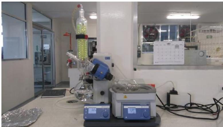
**Figura 2. 3** Concentración de extraíbles con etanol en rotavapor.
