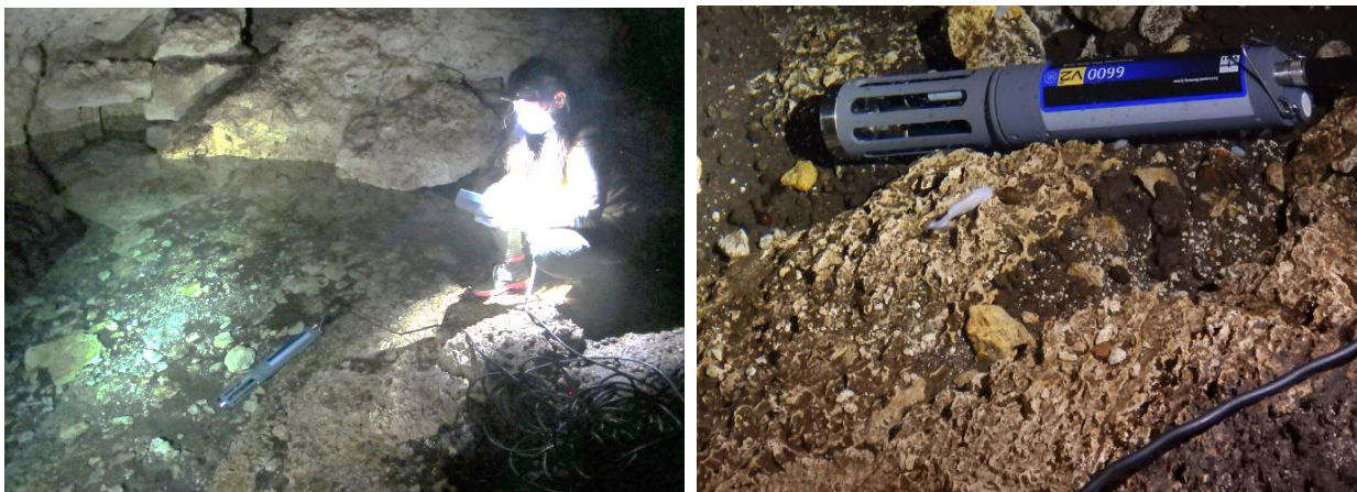
Figura 5.. a) Sección expuesta del acuífero, b) sonda multiparamétrica ( MarcaYSI, modelo 6600V2)
