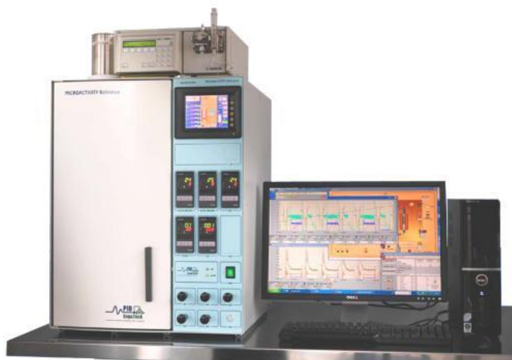
Figura 2.4 Reactor continuo de lecho fijo PID Eng & Tech modelo Microactivity Reference.
