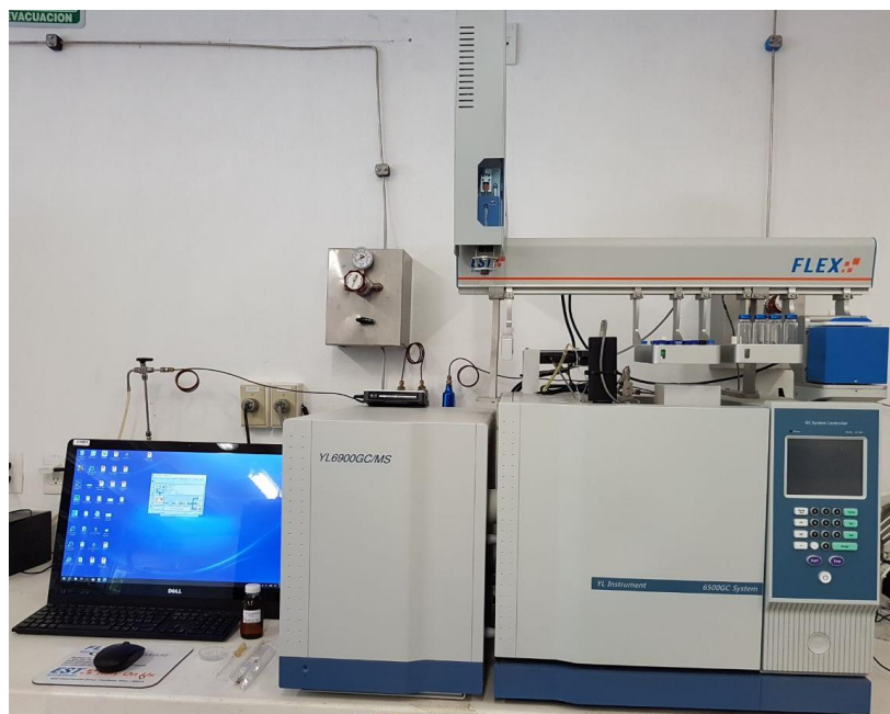
Figura 2.5 CG-EM YL Instrument empleado para analizar los productos de reacción.
