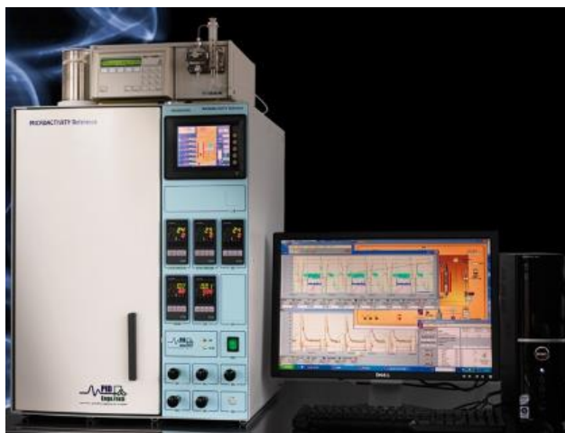
Figura 2.10 Reactor de lecho fijo empleado en los experimentos catalíticos.
