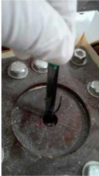
**Figura 16.** Muestra de fibras de carbono y nanotubos de carbono al ser depositada en el equipo generador de campo magnético
