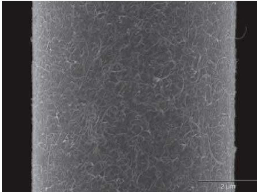
**Figura 7.** Micrografía SEM de los nanotubos de MWCNTs tratados con polietilenimina PEI y depositados en la fibra de carbono [42]
