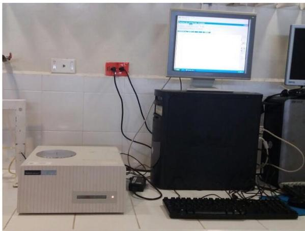
**Figura 2.7** Calorímetro Diferencial de Barrido utilizado en el análisis DSC
