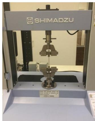
**Figura 2.9** Ensayo de tensión de las probetas
