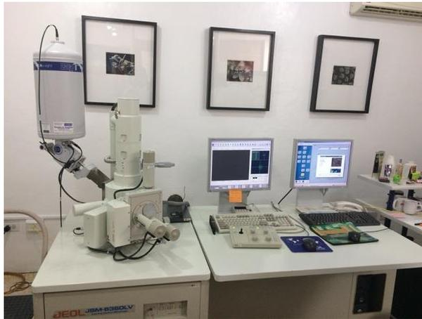
**Figura 2.10** Microscopio utilizado para las pruebas SEM
