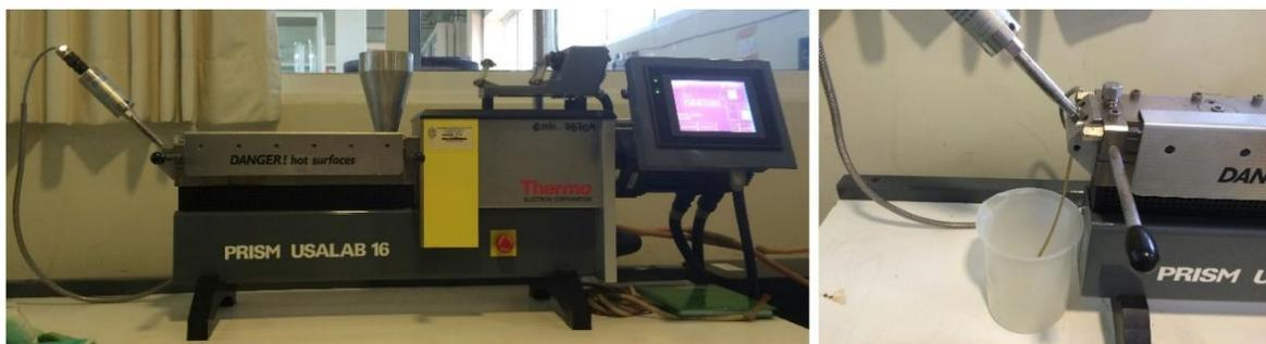
**Figura 2.2** Extrusión de la mezcla de almidón, glicerol y partículas
