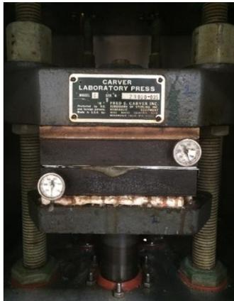
**Figura 2.3** Proceso de prensado de los pellets de TPS con partículas de la testa de la semilla de pich para la obtención de las diferentes películas
