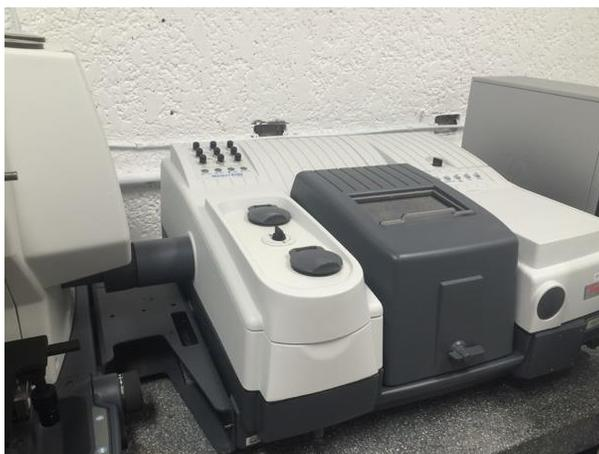
*Figura 2.6* Espectrómetro utilizado para el análisis FTIR
