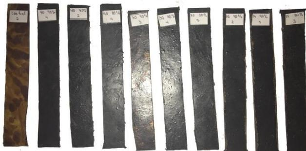
**Figura 2.8** Probetas de la matriz (TPS de pich) y de los materiales compuestos (TPS de pich/PSP)
