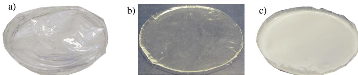
**Figura 4.3. Películas de PS obtenidos de las soluciones de PS, a) CF secado a  $60\text{ }^{\circ}\text{C}$ , b) CF secado a  $25\text{ }^{\circ}\text{C}$  y c) LN secado a  $60\text{ }^{\circ}\text{C}$ .**
