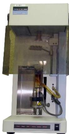
**Figura 3.11. Equipo Termogravimétrico, marca Perkin-Elmer TGA7**
