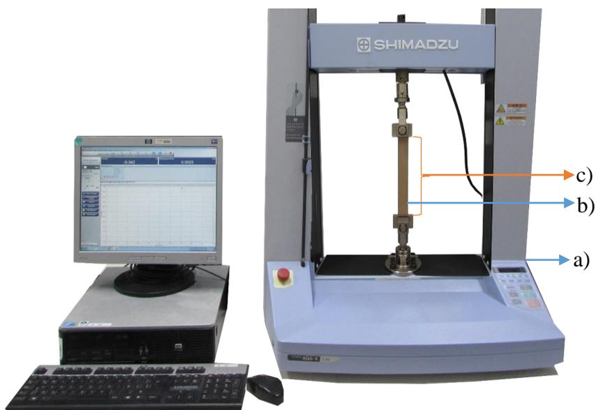
**Figura 3.20. Ensayo mecánico a tracción, a) equipo, b) muestra y c) separación inicial.**
