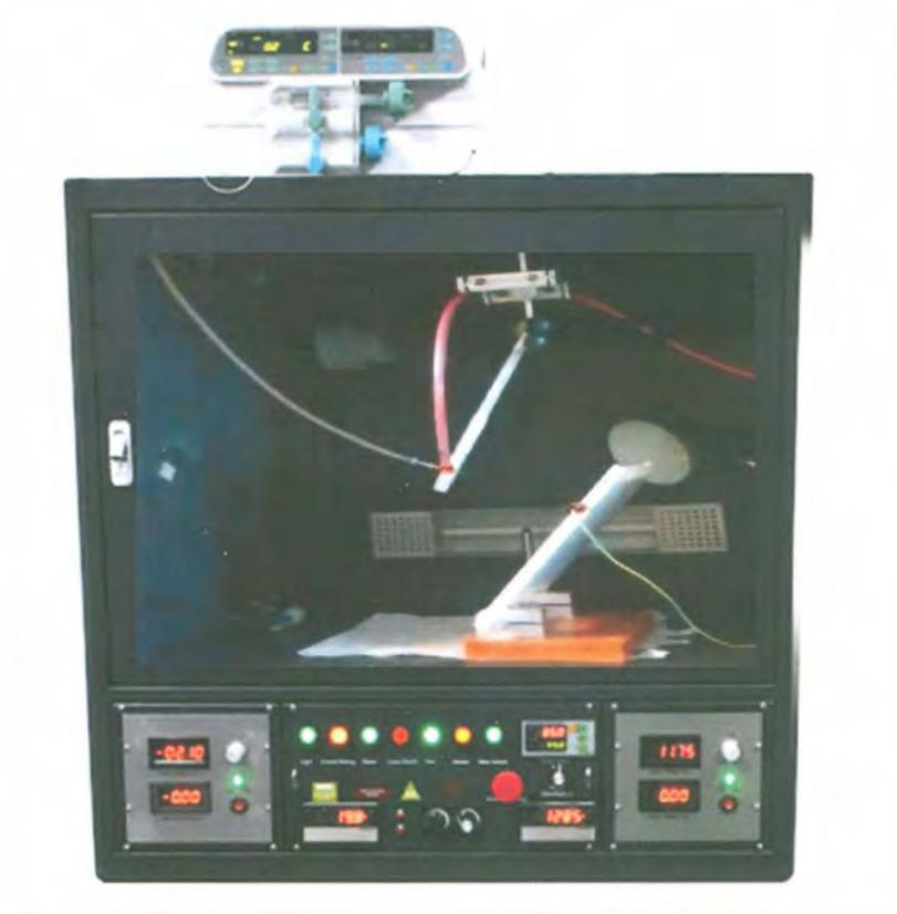
Figura 2. 2. Configuración del equipo de electrohilado situado en el laboratorio de fisicoquímica de la unidad de materiales del CICY.
