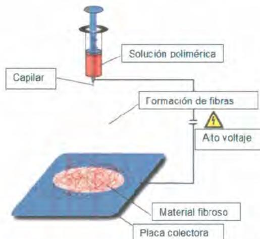
Figura 1.6. Representación esquemática de la técnica de electrohilamiento<sup>[26]</sup>.
