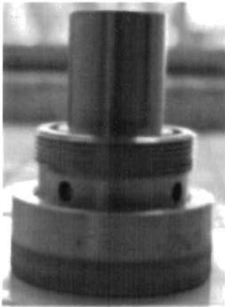
Figura 2.6. Molde cerrado después de la colocación del Elvacite 2043
