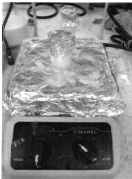
Figura 12.-Mezclado de PCL con 20% y 30% de PLGA
