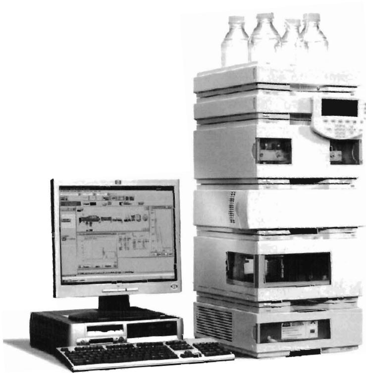
**Figura.2.10** Equipo de HPLC Agilent series 1100
