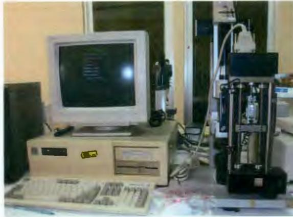
Figura 2.2. Equipo Minimat utilizado para las pruebas de flexión.
