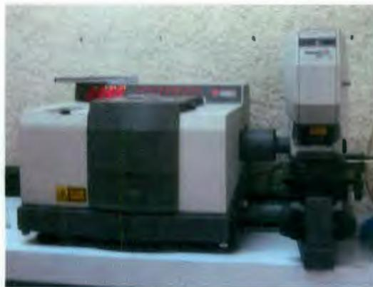
Figura 2.4. Espectrofotómetro FT-IR Nicolet, modelo Protegé 460 utilizado para el análisis de las muestras.
