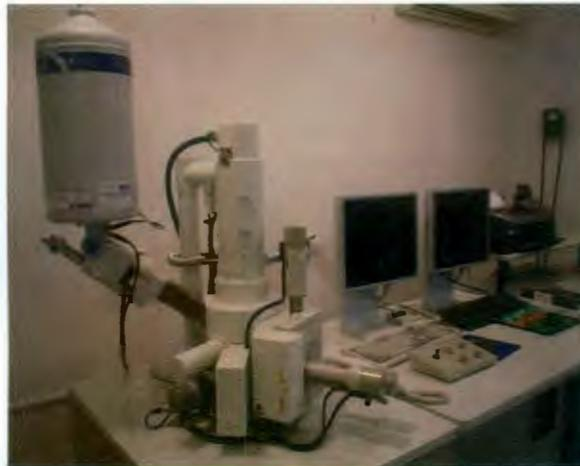
Figura 2.5. Microscopio electrónico de barrido utilizado para el análisis de las muestras.
