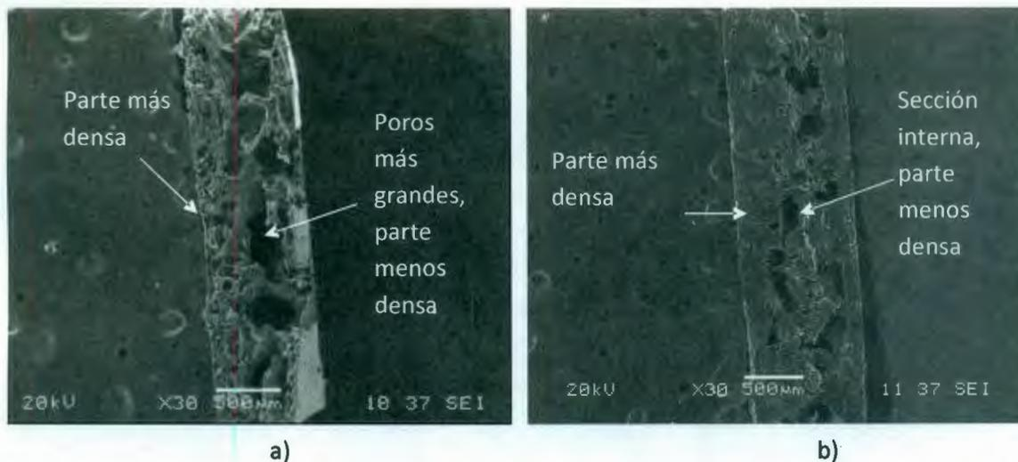
Figura 3.6 Sección transversal del material compuesto (a) MCE3 y (b) MCE10.
