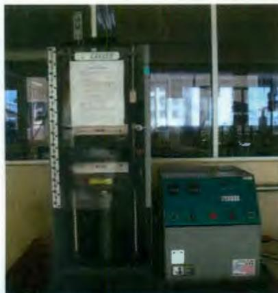
Figura 2.1. Prensa Carver utilizada para la obtención de materiales compuestos espumados.
