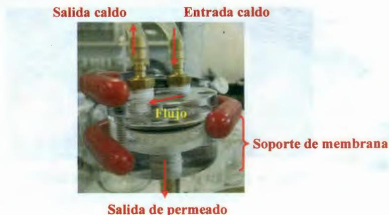
**Figura 2.6.** Dispositivo de filtración de flujo cruzado
