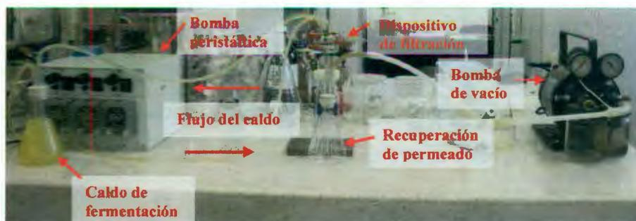
**Figura 2.7.** Sistema de filtración del proceso de separación y concentración de ácido láctico
