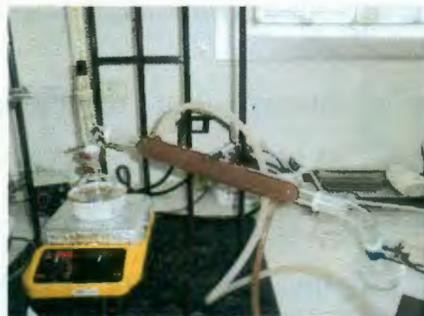
**Figura 2.10.** Purificación y oligomerización del ácido D,L-láctico
