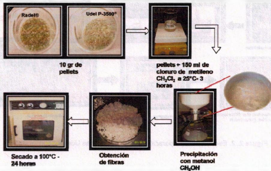
Figura 2. 1. Esquema de purificación de las fibras de polisulfona Udel P-3500® y Radel®.
