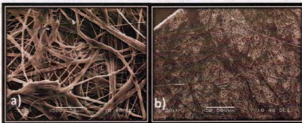
**Figura 3. 2.** Micrografías de la cara inferior de la membrana comercial Sterlitech®.
