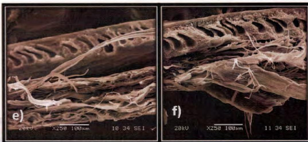
**Figura 3. 4.** Micrografías transversales de la membrana comercial sterilitech®.
