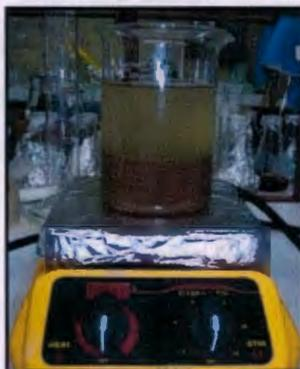
Figura 2.1. Tratamiento hidrotérmico de las fibras de bagazo de *Agave Tequilana*
