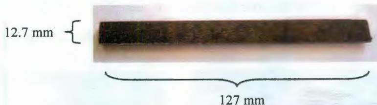
Figura 3.10. Probeta para ensayos a flexión según ASTM D790.
