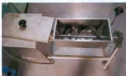
Figura 3.5. Mezcladora de cinta marca Intertécnica con capacidad de 5 L.
