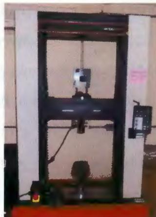
Figura 3.13. Máquina de pruebas universales INSTRON modelo 1125.
