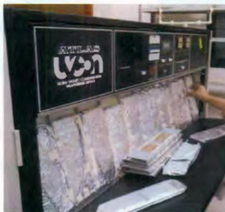
Figura 3.9. Cámara de envejecimiento acelerado ATLAS/UVCON.
