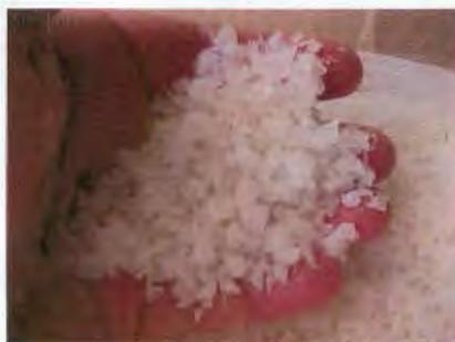
Figura 3.2. Polietileno de alta densidad reciclado.
