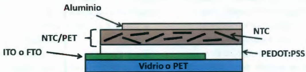
Fig. 1.8 Arreglo tipo sándwich de una celda solar orgánica [37].
