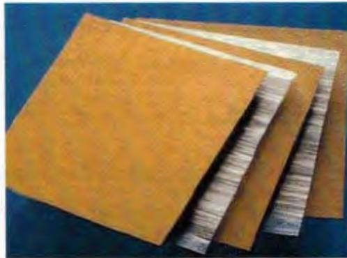
Figura 1.8. Estructura de GLARE 2-3/2-0.4.
