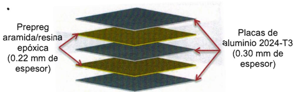
Figura 1.7. Representación de la estructura del ARALL 2.
