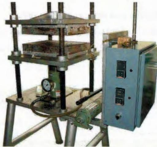
Figura 2.12. Prensa manual con calentamiento-enfriamiento controlado.
