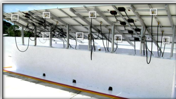
Figura 33. Ubicación de los sensores de temperatura de superficie instalados en los módulos fotovoltaicos.
