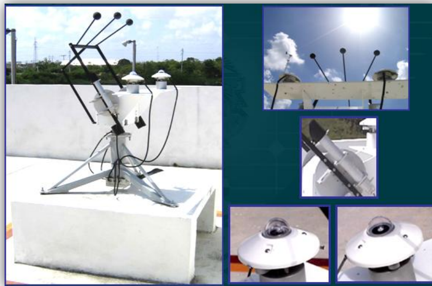
Figura 29. Vista general de la estación solarimétrica (izquierda) y vista de los sensores empleados para medición de los componentes de la radiación solar.
