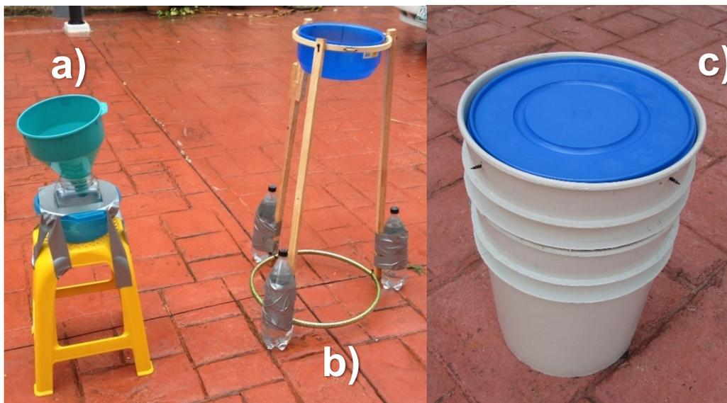
*Figura 2. Prototipos de colectores de agua de lluvia a) banco de plástico con recipiente de plástico que sostiene a un frasco de vidrio, en el cual se encuentra el embudo de plástico por donde entraría el agua de lluvia; b) estructura de madera de tres extremidades y botellas de plástico con agua para evitar la caída del sistema debido al viento; c) dos cubetas empalmadas con un recipiente de plástico en la parte superior.*
