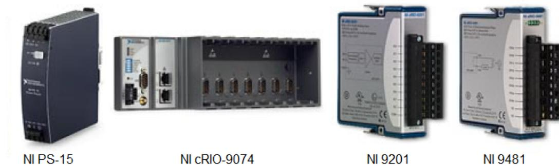
Figura 2.9 Hardware del controlador del SHM.
