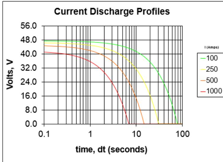
Figura 3.27 Curvas de descarga del módulo de SC Maxwell BMOD0165.
