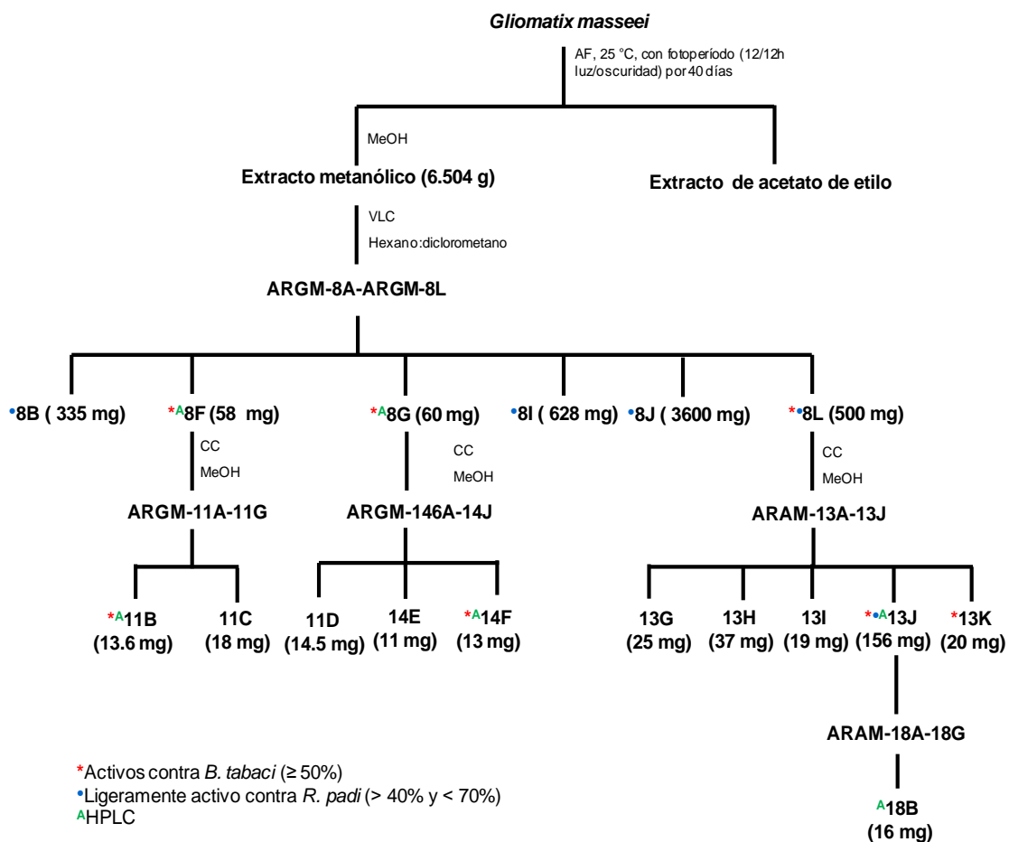
Figura 4.3 Esquema de purificación del extracto metanólico de Gliomatix masseei .
