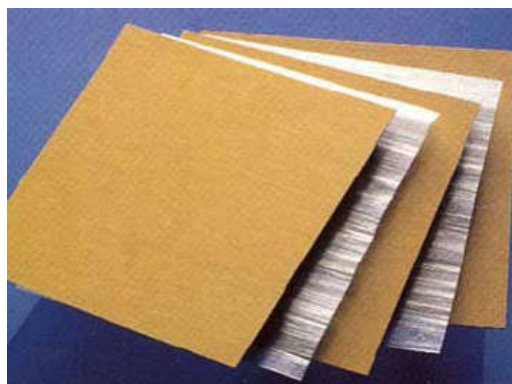
Figura 1.3. Estructura de GLARE 2-3/2-0.4 [3] .
