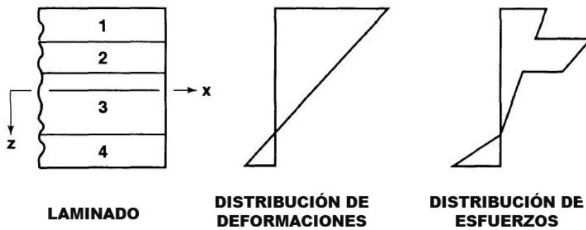
Figura 1.11. Variación de esfuerzos y deformaciones a través del espesor del laminado
