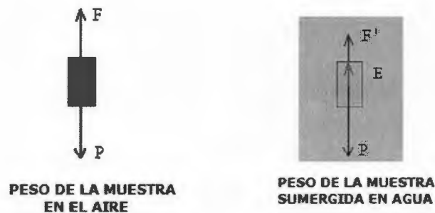
Figura 2.5 Peso de la muestra en el aire y sumergida en agua.
