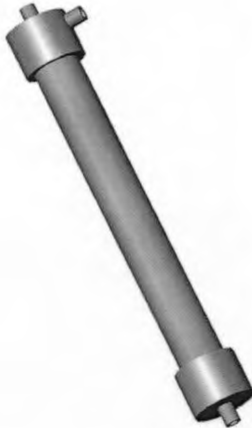
Figura 2.12 Carcasa del módulo en espiral.
