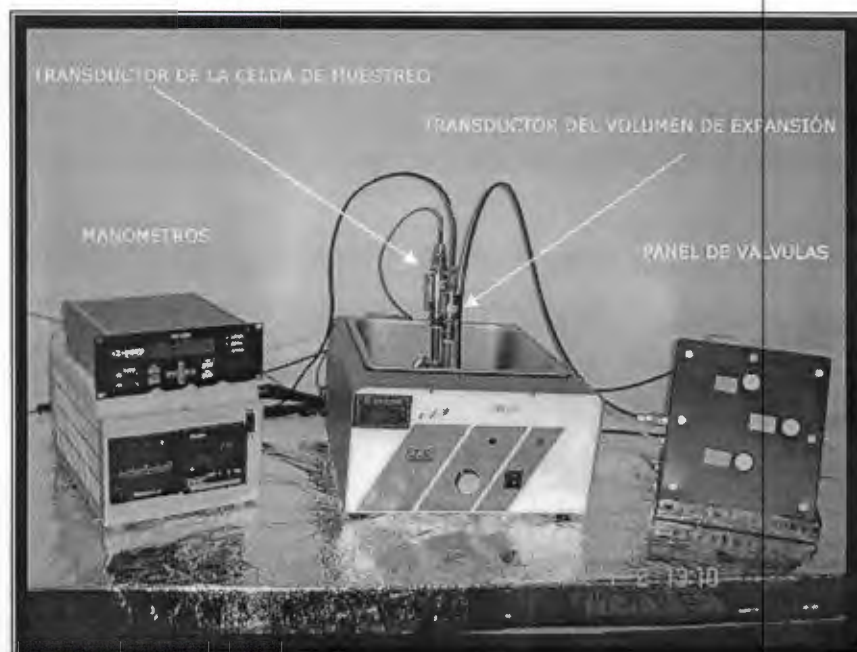
Figura 2.7 Equipo de absorción de gases por decaimiento de la presión.
