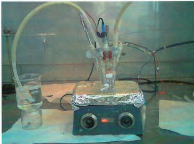
*Figura 3.9. Celda electroquímica de cinco bocas*
