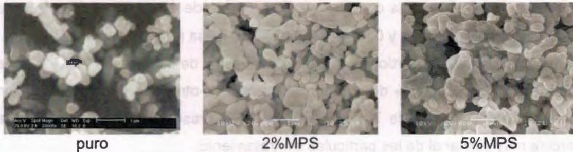
Figura 3.4 Imágenes de SEM del BaSO<sub>4</sub> sin tratamiento y silanizadas al 2% y 5%
