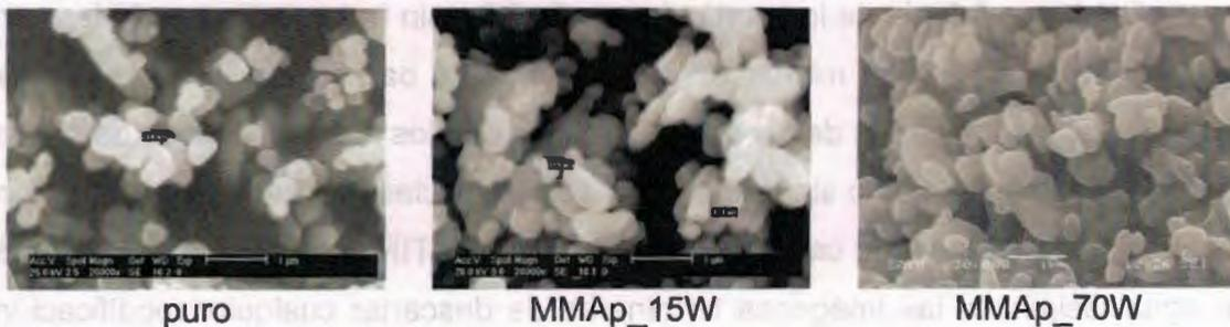
Figura 3.5 Imágenes de SEM del BaSO<sub>4</sub> sin tratamiento y tratado con plasma de MMA
