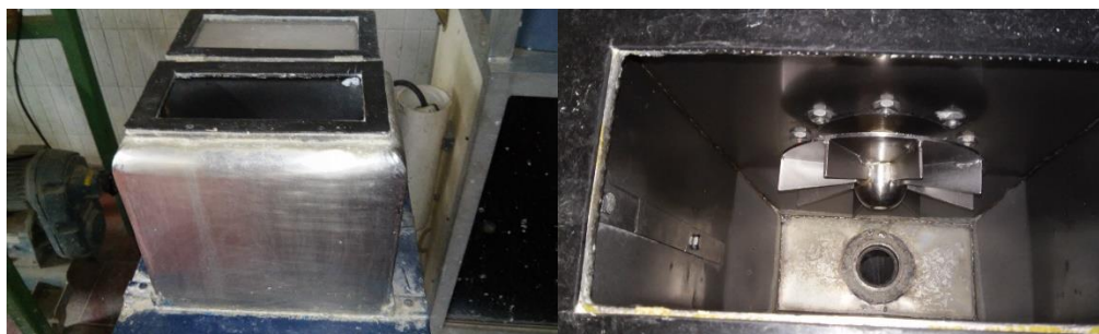
Figura 2.1. Hidrapulper de acero inoxidable, provisto con propela lateral
