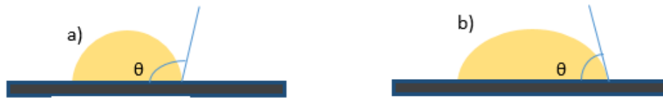
Figura 1. 10. Esquematzación de la “mojabilidad” en la técnica ángulo de contacto, a) ángulo de contacto \geq 90^\circ b) ángulo de contacto \leq 90^\circ .
