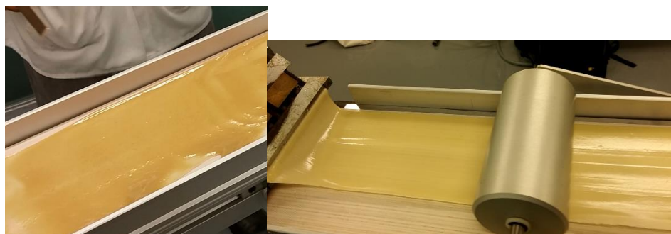
Figura 3.12. Material compuesto extruido en láminas de 1 mm de espesor.
