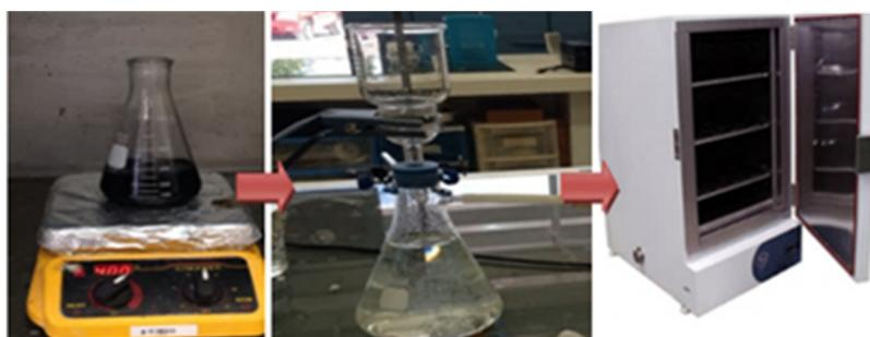
**Figura 2.6** Proceso de lavado con HCl y posterior secado para la remoción de la base de KOH, muestra BPA700.
