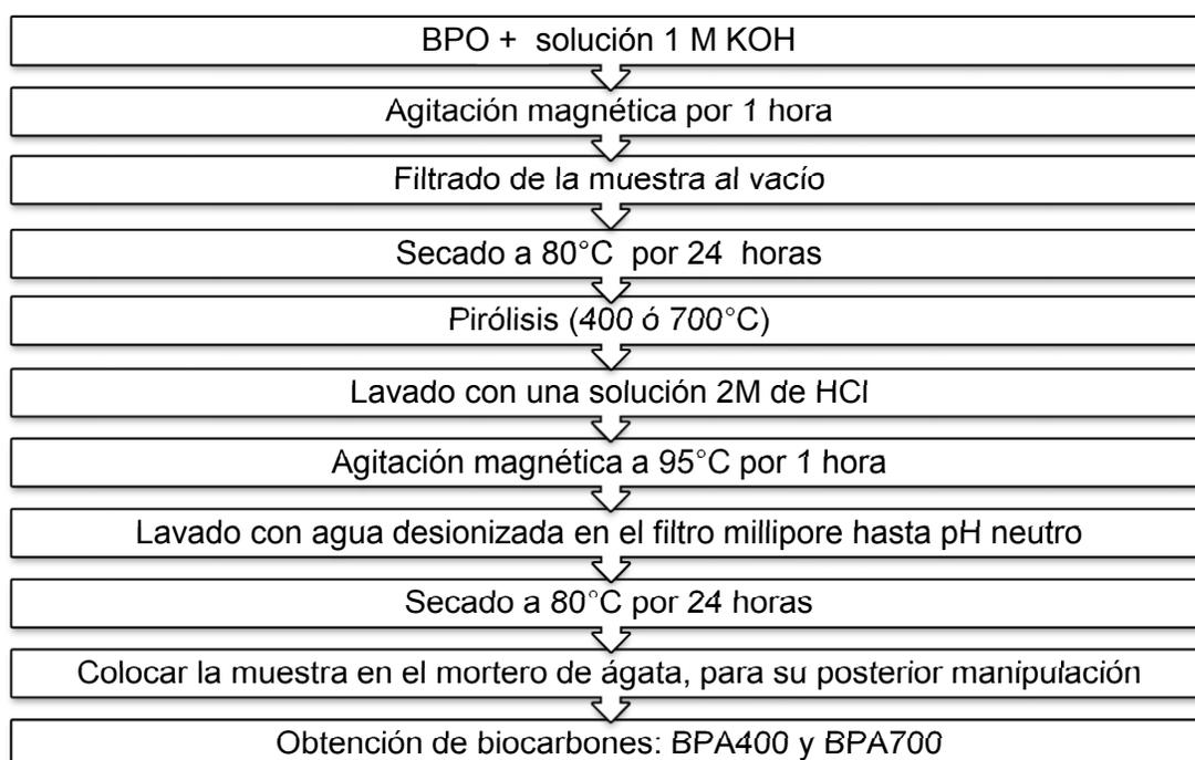
**Figura 2.4** Diagrama del proceso de obtención de electrocatalizadores a partir de la materia prima (BPO).
