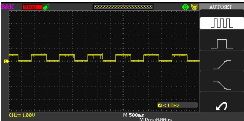
**Figura 3.19** Pulsos generados por el control PI ON-OFF.
