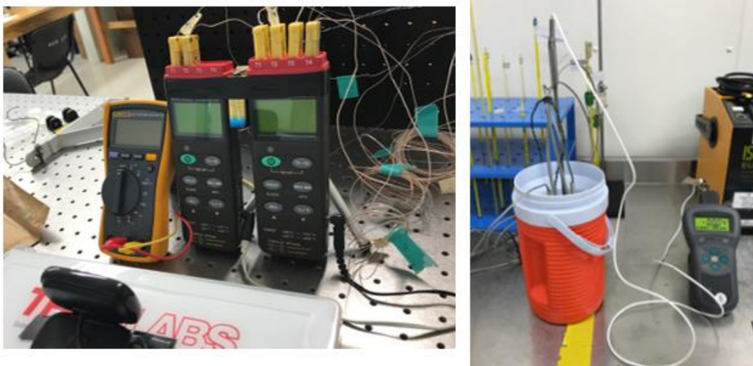
Figura 2. 13. Calibración y ajuste de data loggers.
