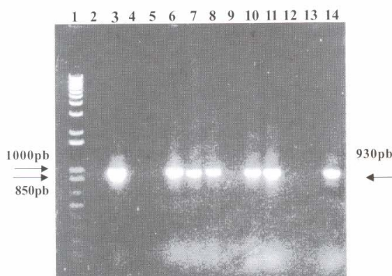
Fig. 1. Detección de fitoplasmas del amarillamiento letal por medio de PCR anidado usando los iniciadores específicos 503f y LY16Sr. El carril 1 es un marcador de peso molecular con banda de 12 Kb. La Banda de 930 pb denota amplificación positiva; Los carriles 2 y 3 fueron testigos negativos y positivo, respectivamente. Los carriles 4 al 14 fueron muestras extraídas de palmas del bloque estudiado. Los carriles 6, 7, 8, 10, 11 y 14 son muestras con resultado positivo al fitoplasma y corresponden a palmas con síntomas de AL.
