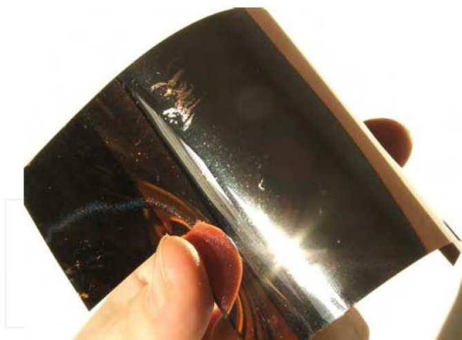
Figura 1.5 Película flexible de UPILEX® con una base de CdTe y una capa de contacto de Cu de 2 \mu\text{m} .
