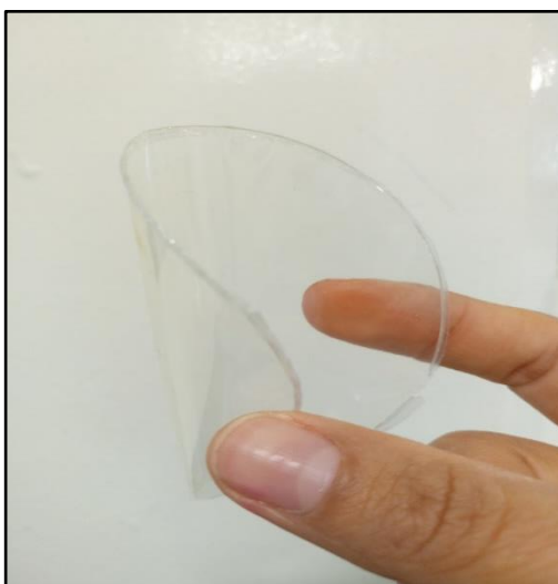
Figura 3.19 Película de co-poliámida DDTD flexible y transparente
