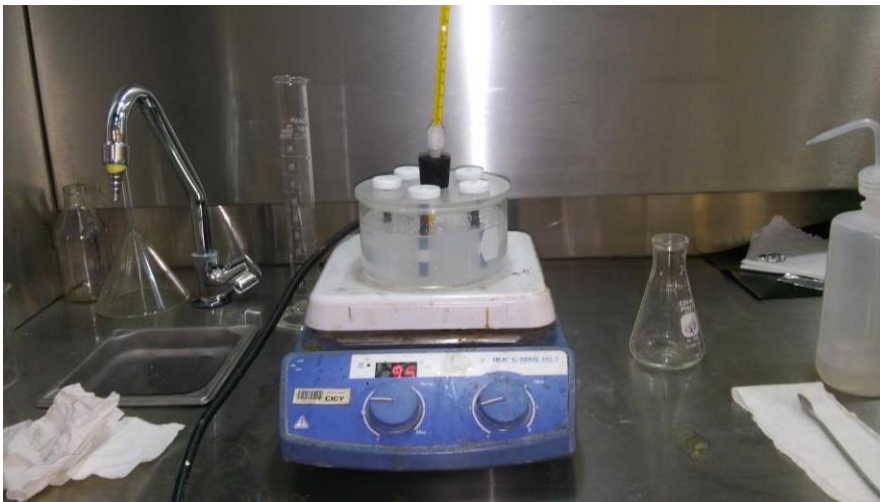
Figura 2.5 Esquema del sistema de baño químico de ZnS.
